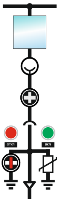
Рис.1.40 Состояние мнемосхемы при нахождении ВЭ в ремонтном положении
