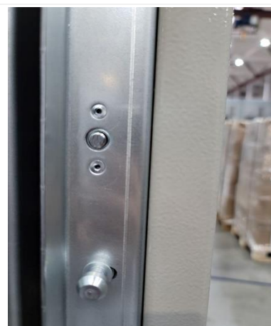
Рис. 2.24 Механизм деактивации блокировки (вид при открытой двери отсека)
