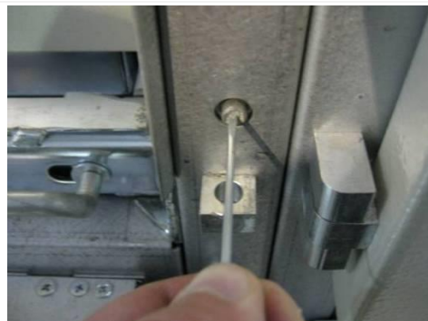
Рис. 2.24 Механизм деактивации блокировки (вид при открытой двери отсека)
