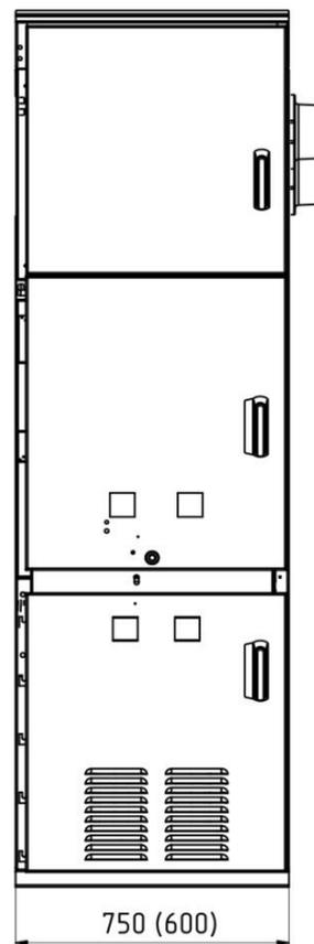
Рис. П2.7 Шкаф КРУ D-12Р с измерительными ТН
