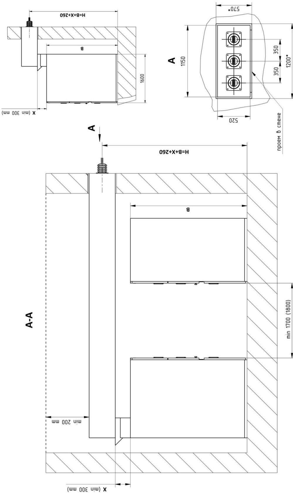
**Рис. П6.3** Вариант размещения в помещениях РУ с шинным вводом.
