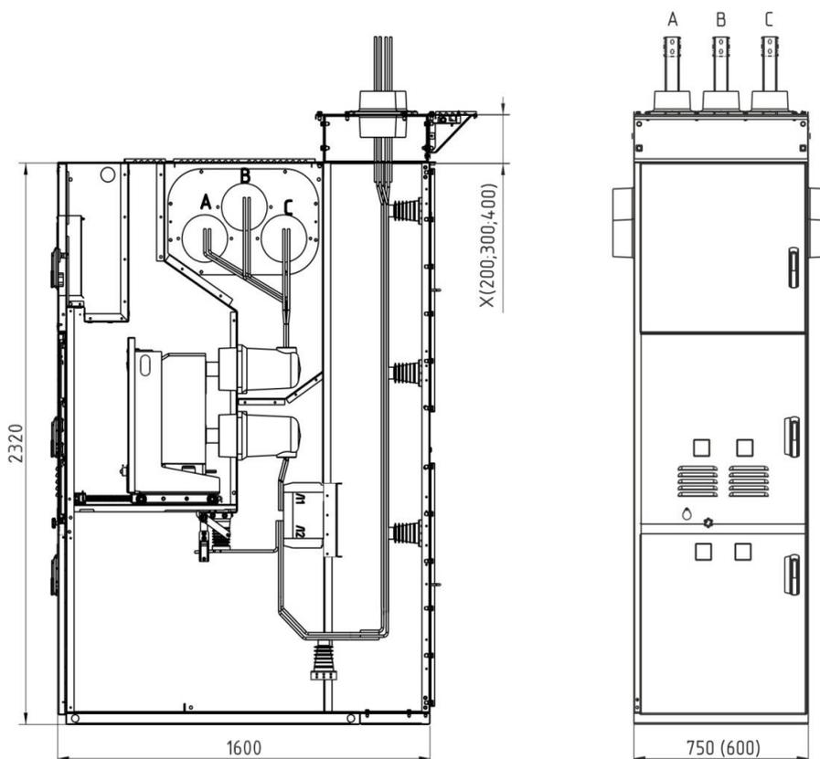
**Рис. П2.2** Шкаф КРУ D-12P с шинным вводом через заднюю приставку на номинальный ток до 2000 А
