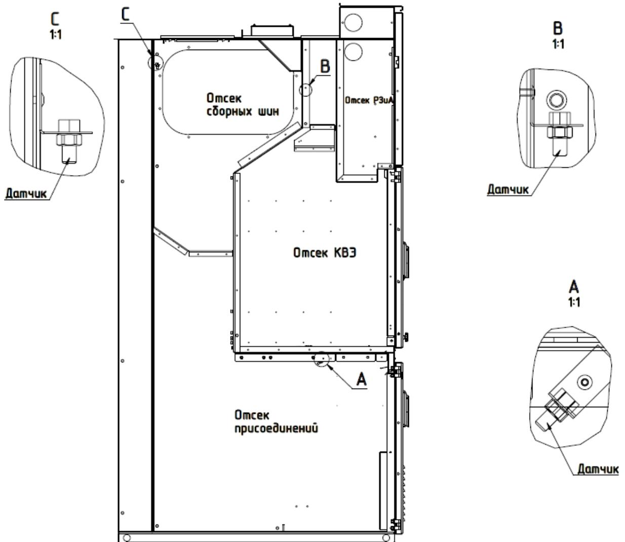
Рис.П7.1 Размещение оптических датчиков в шкафу
